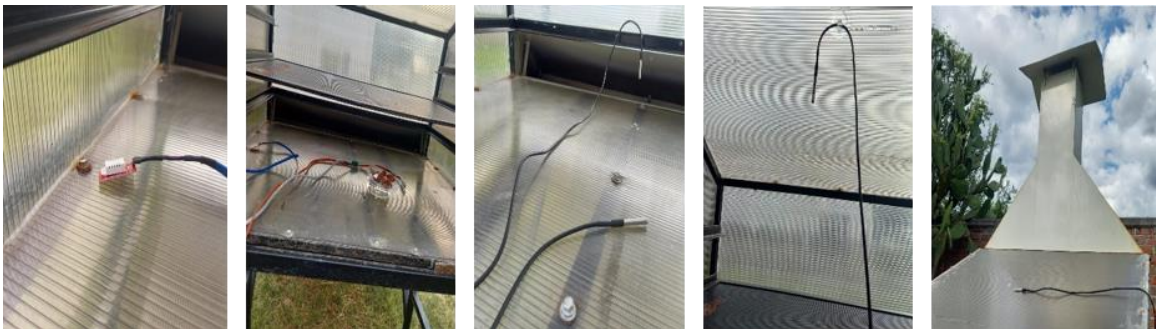
Figura 25. Colocación del sistema de adquisición de datos en el secador solar mixto.
